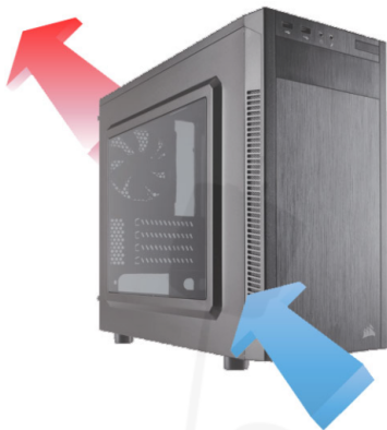
1| Meleg levegő kiszívásos kényszerített konvekció
